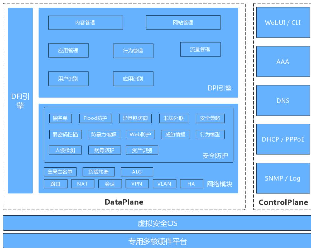
传统的网关设备为了降低设计和开发难度，会将各功能模块对应不同的进程，数据包每通过一个模块都要对数据进行解析。增加了数据包在系统停留的时间，从而造成了网络延迟大的问题。
