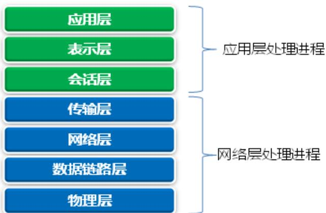
DAS-Gateway 的 DP 主要处理转发相关的工作，通过对数据包一次解析，按层次由对应模块处理，可以节省不同模块间重复解析数据包所消耗的资源，从而降低网络延迟。
