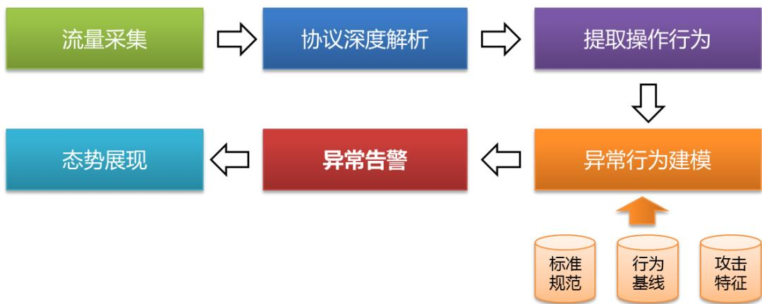
工控安全审计系统能够分析工控现场中的操作是否符合定义的操作要求，如发现其中有任何的违规操作及时进行报警。系统主要通过旁路部署的方式对工业生产过程进行零风险的监测与记录，基于对工业控制协议(如 IEC 60870-5-101、102 和 104 协议、IEC 61850、IEC 61970、ICCP、MODBUS TCP、PROFINET 等)的通信报文进行深度解析，能够实时检测针对工业协议的网络攻击、用户误操作、用户违规操作、非法设备接入以及蠕虫、病毒等恶意软件的传播并实时报警，同时详实记录一切网络通信行为，包括指令级的工业控制协议通信记录，为工业控制系统的安全事故调查提供坚实的基础。
